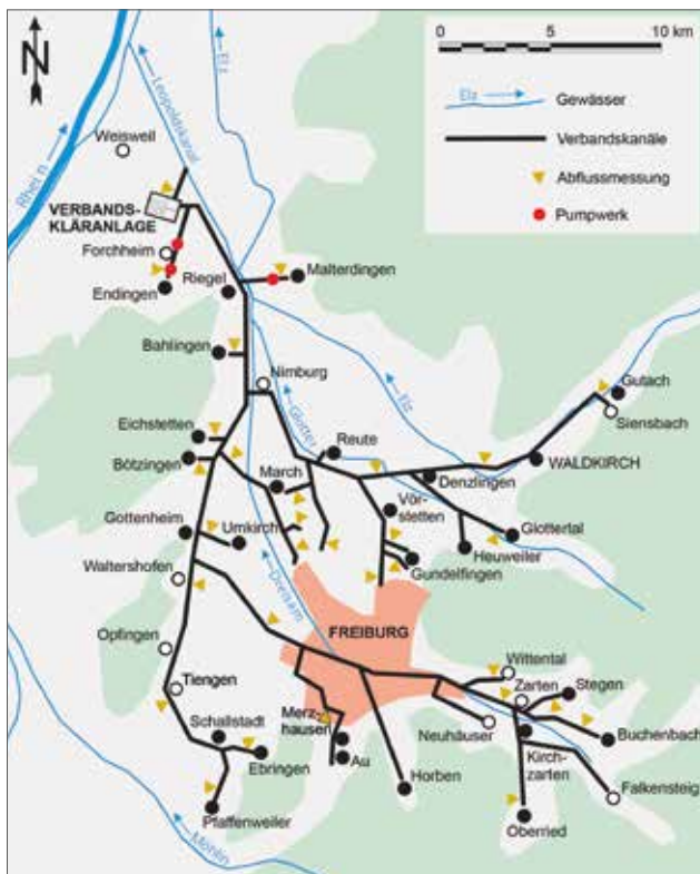
Verbandsgebiet mit Kanälen und Messstellen
